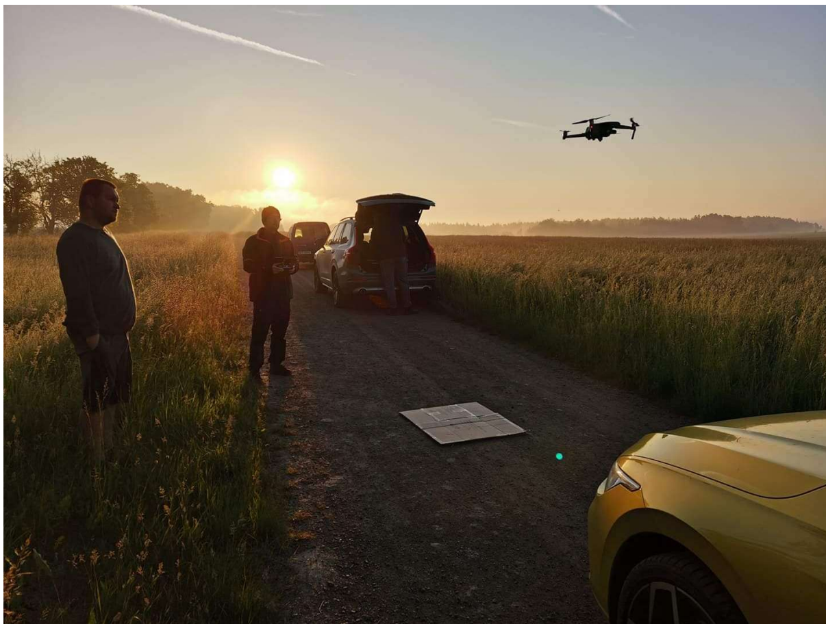
Jako heliport může posloužit třeba kus kartonu - nevzlétejte z prašné cesty, hrozí poškození gimbalu
